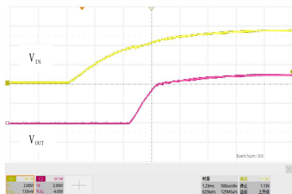
图 18. 软启动, V_{IN}=5.5V , V_{OUT}=5.0V , I_{OUT}=3A
