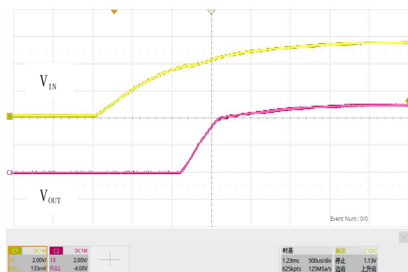
图 18. 软启动, V_{IN}=5.5V , V_{OUT}=5.0V , I_{OUT}=3A
