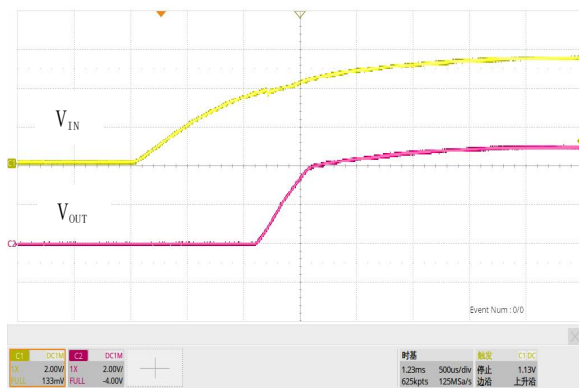
图 18. 软启动, V_{IN}=5.5V , V_{OUT}=5.0V , I_{OUT}=0.5A
