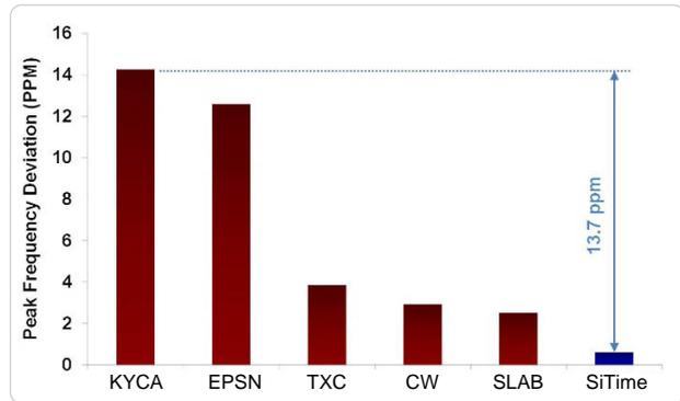
Figure 20. Shock Robustness<sup>[6]</sup>
