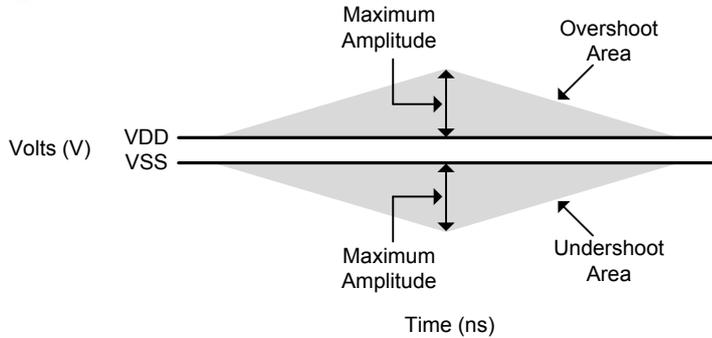
**Table 23. AC overshoot/undershoot specification for clock, data, strobe, and mask pins (DQ, DQS, DQS#, RDQS, RDQS#, DM, CK, CK#)**
