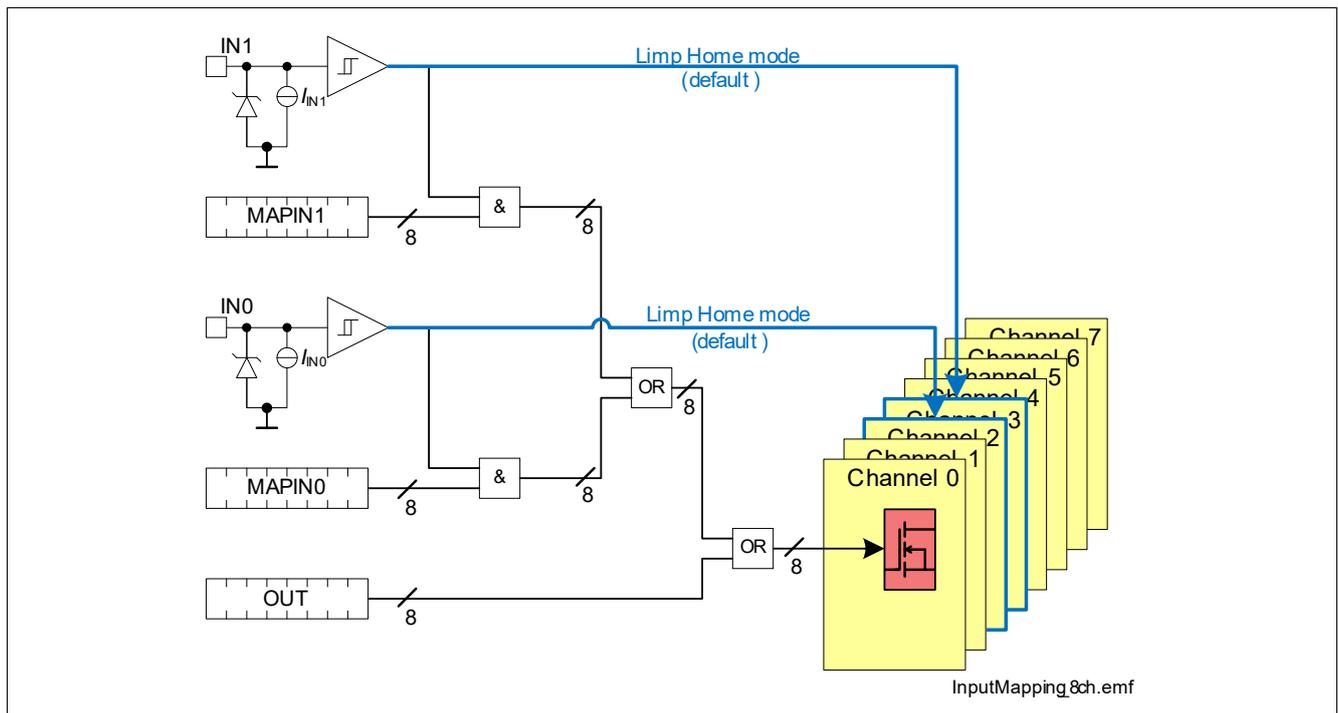
**Figure 10 Input Mapping**
